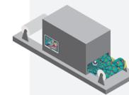
Schattdecor ermöglicht Dekor-druck in neuen Dimensionen. So sind wir bei der Rapportlänge nicht mehr länger an den Zylinderumfang gebunden. Die Single-Pass Anlage Palis 2250 druckt mit den vier Stammfarben Rot, Gelb, Blau und Schwarz sowie einer optionalen fünften Farbe. Die Pigmente sind identisch mit jenen im Tiefdruck. Viele Dekore sind somit im Tief- wie im Digitaldruckverfahren abbildbar und optisch praktisch nicht voneinander zu unterscheiden.
