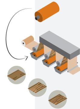
Im Rotationstiefdruck tragen gravierte Zylinder vorgemischte Farben über eine Druckwalze auf das Papier auf. Bei besonders komplexen Mustern kommen bis zu vier Zylinder zum Einsatz.
