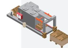
In diesem Schritt erhält das bedruckte Dekorpapier im Tauchverfahren eine Beschichtung aus Melaminharz. Dank unseres umfassenden technologischen Know-hows sind unsere Kunden in der Lage, eine äußerst robuste Oberflächenveredelung für Möbel, Arbeitsplatten, Innenausbau und Böden zu erreichen.
