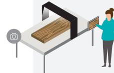
Zur Entwicklung der Dekore nutzen wir verschiedenste Originalvorlagen und erzeugen über Scans hochauflösende digitale Druckvorlagen.
